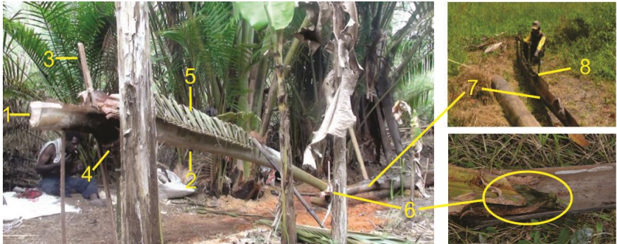
Gambar 12. Rangkaian alat pangkur sagu tradisional : (1) kosanggod ; (2) apuan ; (3) dapaa ; (4) roon ; (5) pondu ; (6) pendu ; (7) bing ; (8) pendol .
